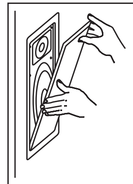
6) Instale la Rejilla
